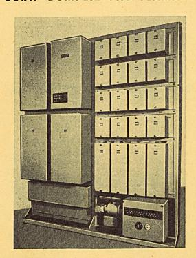
Telephonautomat auf der Grundlage des Kreuzwählerprinzips
