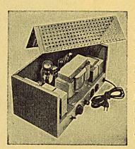
anwendbar für Verbraucher 150 bis 45 000 VA, ein- und dreiphasig. Genauigkeit: 1°/00 vom Sollwert, lastunabhängig. Frequenzunabhängig, gute Kurvenform,
