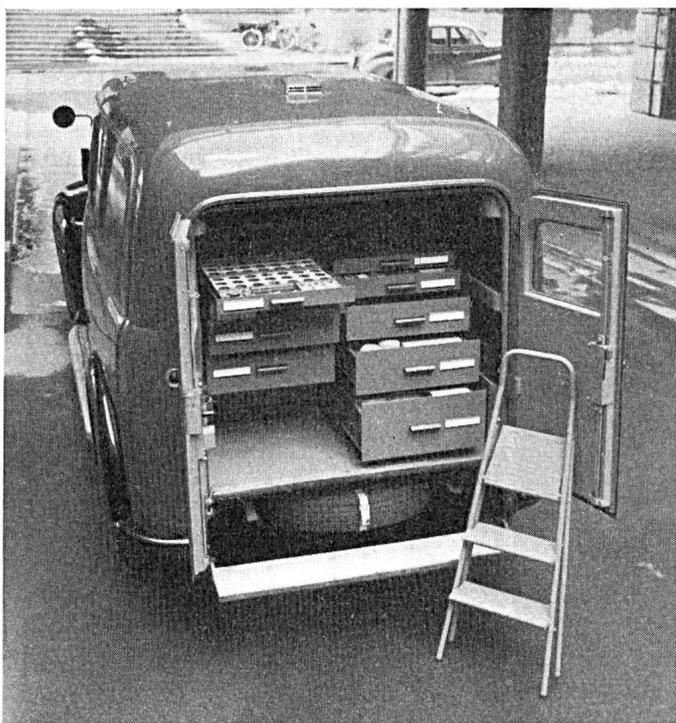
Fig. 4. Ausrüstung eines Fahrzeuges für den Unterhaltsdienst
