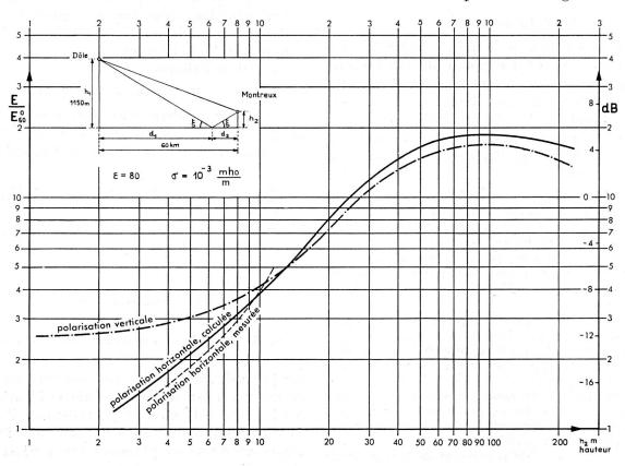
Fig. 4. Champ en fonction de la hauteur à Montreux pour polarisations horizontale et verticale
