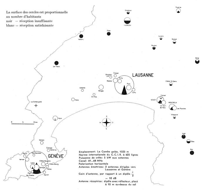
Fig. 7. Conditions de réception d'un émetteur de télévision de 5 kW placé à la Dôle
