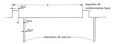
Fig. 3. Train d'impulsions pour les mesures de réflexions
