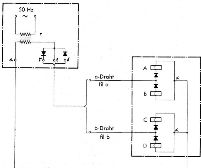
Fig. 1. Prinzip des Wählvorganges mittels Halb- und Ganzwellen
