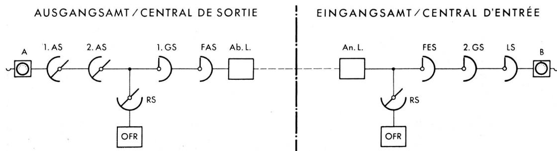
Fig. 3. Verbindungsdiagramm einer 4-Frequenz-Fernverbindung
