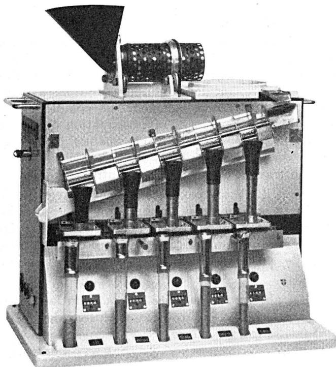
Fig. 1. Die Münzzähl- und -sortiermaschine mit abgedecktem Münzausscheidkanal
