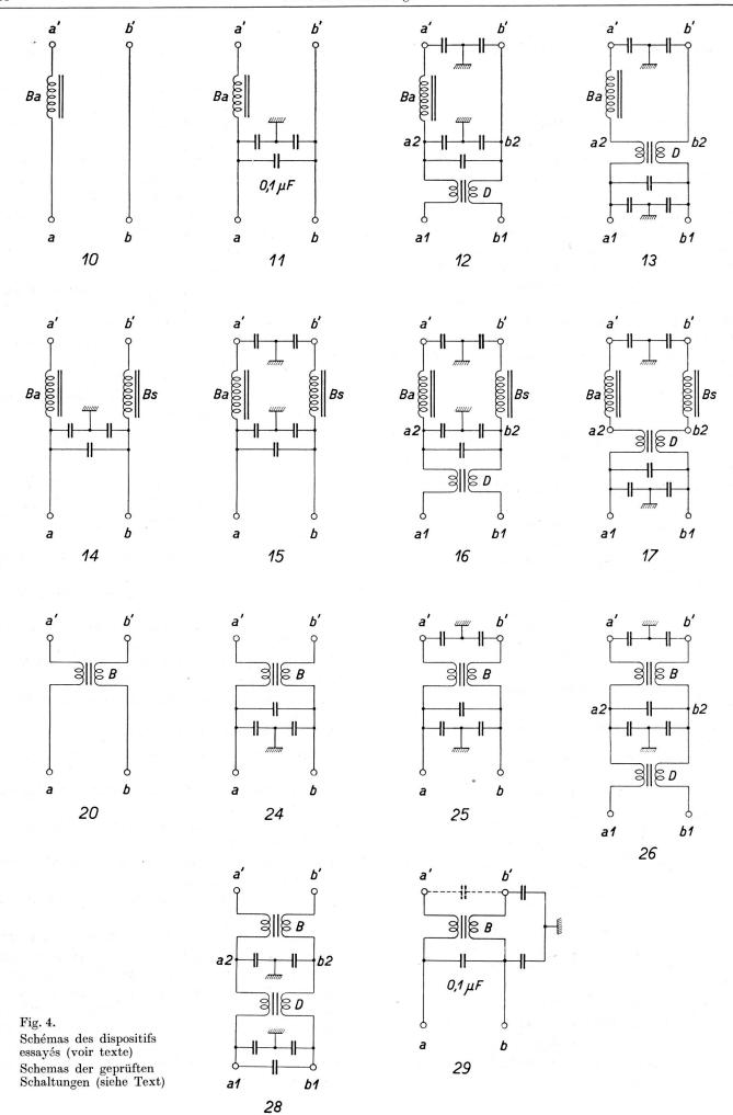
La tension perturbatrice asymétrique entre les conducteurs d'alimentation du dispositif d'éclairage et sa masse subit les modifications indiquées par le tableau II ci-après. On a pris comme niveau de référence la tension perturbatrice aux bornes d'un appareil non déparasité et muni d'une bobine ballast non symétrique (schéma 10).
