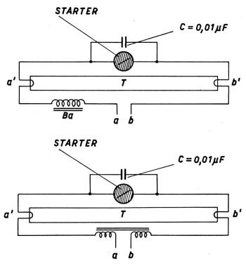
Fig. 2. Schéma de montage - Schaltschema
