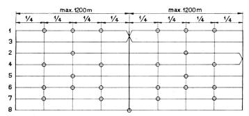
Fig. 12. Vierertraversenleitung mit zwei Schlaufenkreuzungen
