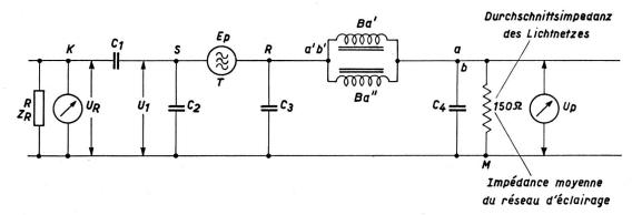
Fig. 3. Schémas HF équivalent – HF-Ersatzschemas
