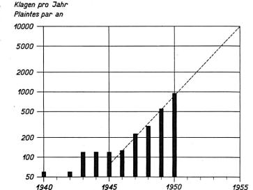
Fig. 1. Nombre des réclamations adresé par les auditeurs suisses à l'administration des PTT au sujet des perturbations radioélectriques dues aux tubes d'éclairage à fluorescence Zahl der durch die schweizerischen Hörer an die PTT-Verwaltung gerichteten Beschwerden betreffend Radiostörungen, verursacht durch Fluoreszenz-Beleuchtungsröhren
