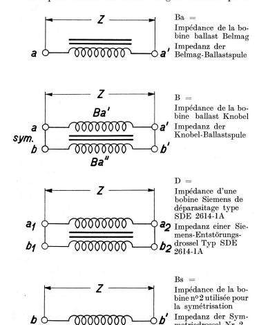
Fig. 5b. Mode de branchement des bobines pour les mesures dont les résultats sont indiqués par la figure 5a Schaltung der Spulen, deren Impedanzen in Figur 5a dargestellt sind
