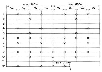
Fig. 10. Beispiel eines Kreuzungsplanes für Vierertraversen
