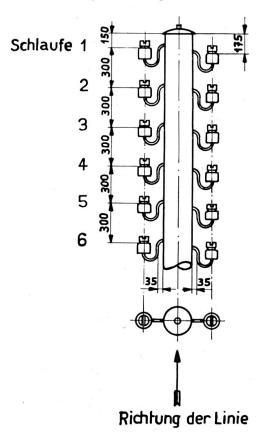
Fig. 2. Bild der Leitung mit Seitenträgern
