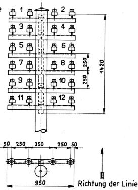
Fig. 1. Bild der Leitung mit Vierertraversen
