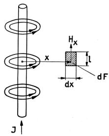
Fig. 3. Magnetfeld eines stromdurchflossenen Leiters
