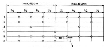
Fig. 11. Beispiel eines Kreuzungsplanes für Seitenträger
