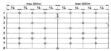
Fig. 12. Vierertraversenleitung mit zwei Schlaufenkreuzungen
