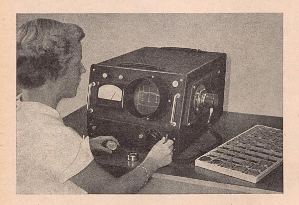
Jede Hörerkapsel muss nach Fertigstellung auf Frequenzgang und Empfindlichkeit geprüft werden.
