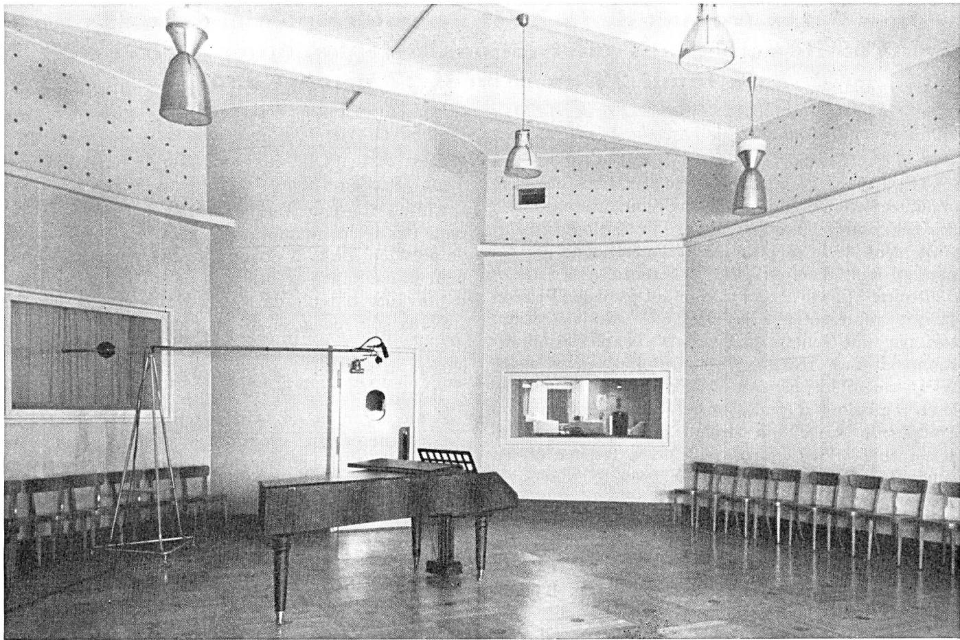
Fig. 5. Radiostudio in Zürich mit Helmholtzresonatoren aus Hohlkammersteinen
