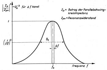
Fig. 12. Verlauf von  $\left| \frac{Z_p}{Z_{po}} \right|^2$  in Funktion der Frequenz
