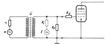
Fig. 14. Ersatzschaltbild einer Eingangsstufe mit einem idealen Übertrager
