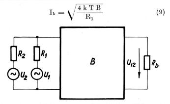
Fig. 3. Ersatzschaltbild zweier parallelgeschalteter Widerstände  $R_1$  und  $R_2$  als Spannungs-Rauschquellen
