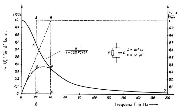
Fig. 9 Spektrum der quadratischen Rausch-EMK einer RC-Parallelschaltung
