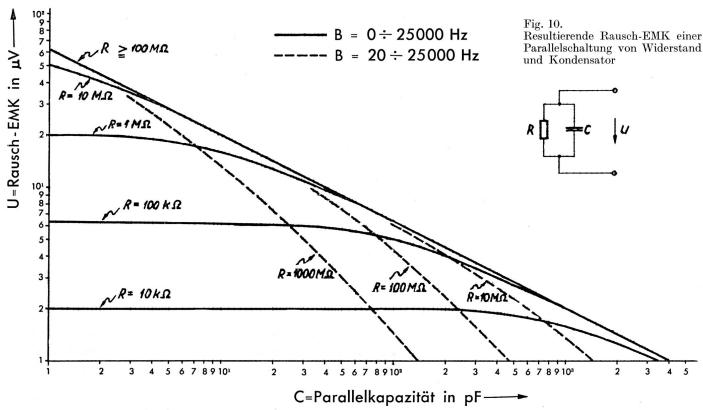
stärkung im Quadrat  $\left(\frac{V}{V_m}\right)^2$  multipliziert. Die graphische Integration der Fläche unter der neuen Kurve von 0 bis 200 Hz ergibt nun 25,4 · 10<sup>8</sup>  $\Omega$  · Hz, gegenüber 23,9 · 10<sup>8</sup>  $\Omega$  · Hz bei der senkrechten Flanke. Die neue Rauschspannung beträgt somit 6,41  $\mu$ V gegenüber 6,22  $\mu$ V im ersten Falle, wenn man sich auf eine obere Grenzfrequenz von 200 Hz bezieht.
