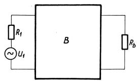
Fig. 2. Ersatzschaltbild eines Wirkwiderstandes  $R_1$  als Spannungs-Rauschquelle.  $U_1$  stellt die Rausch-EMK des als rauschfrei zu betrachtenden Widerstandes dar
