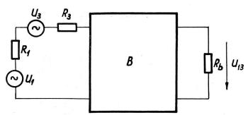
Fig. 4. Ersatzschaltbild zweier in Serie geschalteter Widerstände als Spannungs-Rauschquellen
