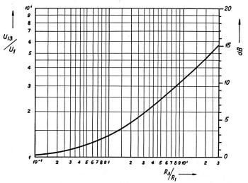
Fig. 6. Verhältnis zwischen der resultierenden Rausch-EMK  $\rm U_{13}$  einer Serieschaltung zweier Widerstände  $\rm R_1$  und  $\rm R_3$  zu der Rausch-EMK  $\rm U_1$  des Widerstandes  $\rm R_1$  als Funktion von  $\rm R_3/R_1$
