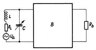
Fig. 11. Ersatzschaltbild für die Betrachtung der Rausch-EMK eines Parallelschwingkreises
