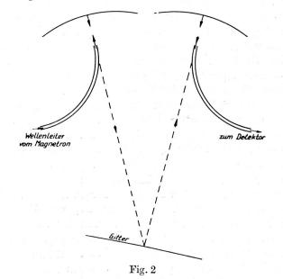
Nach dem Filter wird das Signal gleichgerichtet, verstärkt und angezeigt. Als Detektoren finden sowohl Kristallgleichrichter als auch eine sogenannte «Golay-Zelle», d. i. ein thermischer
