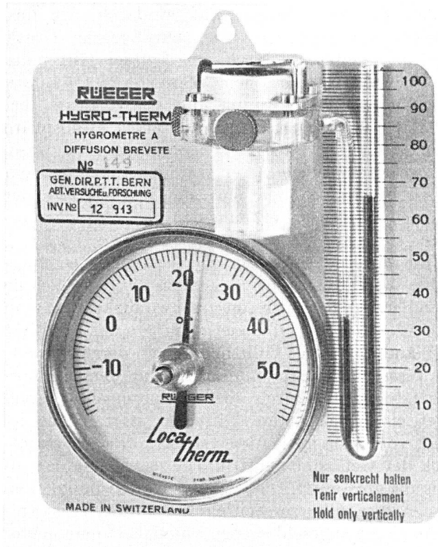
Fig. 12. Diffusionshygrometer nach Greinacher (Firma Rüegger, Lausanne)
