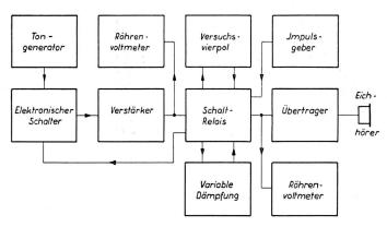
Fig. 1. Blockschema eines Tonfrequenzimpulsgebers
