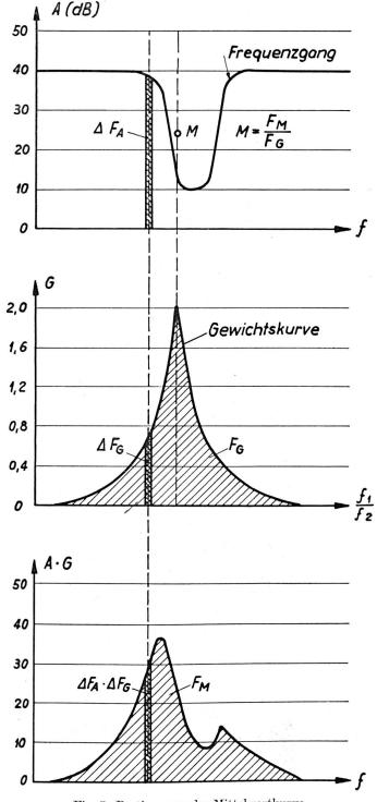
Fig. 5. Bestimmung der Mittelwertkurve
