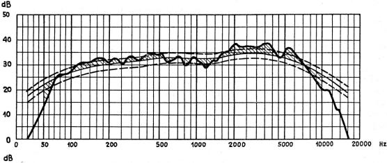
Fig. 11. Amplitudengänge von Lautsprechern
