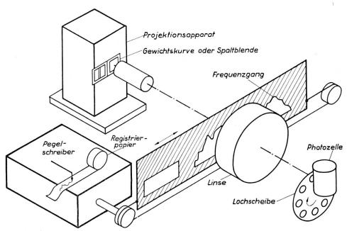
Fig. 6. Versuchsanordnung zur Bestimmung der Mittelwertkurve
