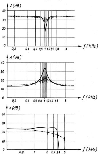
Fig. 3. Frequenzgänge mit den entsprechenden Mittelwertkurven
