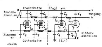
Fig. 21. Prinzipschaltbild eines Verstärkers mit verteilten Verstärkerröhren (additive Verstärkung)
