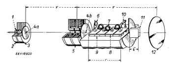
Fig. 20. Darstellung der Konstruktion einer Wanderwellen-Oszillographenröhre [21]
