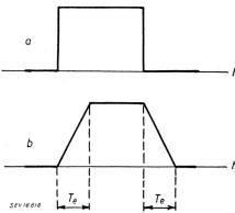
Fig. 18. Wiedergabe eines Impulses durch einen Kathodenstrahl-Oszillographen
