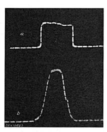
Fig. 23. Wiedergabe eines Impulses von 12 ms Dauer mit Hilfe eines Kathodenstrahl-Oszillographen [24]
