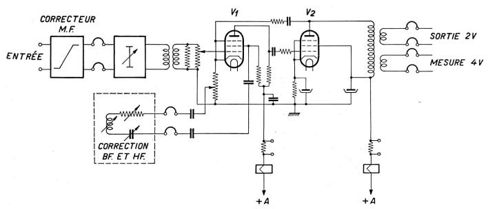
Fig. 1. Amplificateur radiophonique Philips Télécommunication
