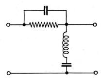
Fig. 5. Correcteur pour les fréquences moyennes
