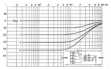
Fig. 7. Correcteur de température pour circuits radiophoniques H-0
