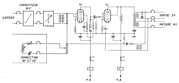
Fig. 2. Amplificateur radiophonique Standard Téléphone et Radio S.A.
