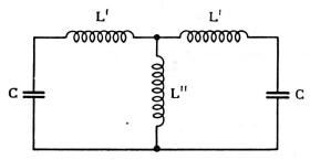
Fig. 7b. Equivalent électrique avec inductivité en T
