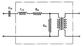
Fig. 6. Schéma équivalent du transformateur électromécanique
