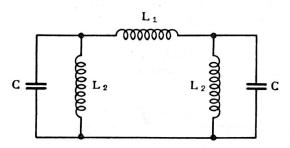
Fig. 7c. Equivalent électrique avec inductivité en  $\pi$
