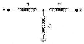
Fig. 7a. Equivalent mécanique du système vibrant avec éléments idéaux
