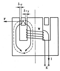
Fig. 5. Transformateur électromécanique
