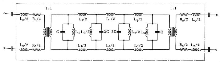
Fig. 8. Schéma équivalent d'un filtre à trois cellules complet
