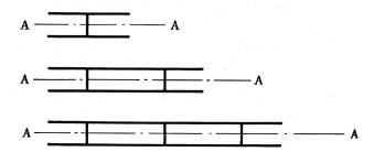
Fig. 1. Système vibrant des filtres électromécaniques en échelle. Filtres à  $1,\ 2$  et 3 cellules
