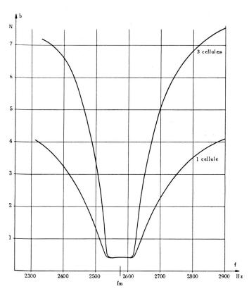
Fig. 10. Affaiblissement composite de filtres électromécaniques
