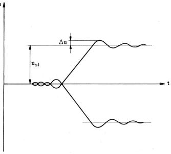
Fig. 12. Enveloppe de la réponse à un front d'impulsion rectangulaire
