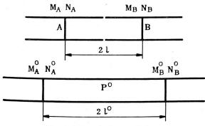
Fig. 4. Filtre à deux cellules En haut: deux cellules couplées par une articulation En bas: deux cellules couplées par une barre élastique
