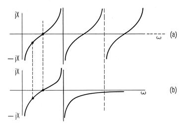
Fig. 7. Impedanzverlauf der offenen Leitung (a) und der Nachbildung (b) nach Fig. 6
