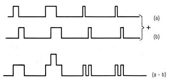
Fig. 4. Impulstrennung mit Laufzeitverschiebung
