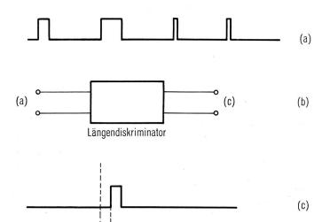
Fig. 1. Wirkungsweise eines Impulslängen-Diskriminators
