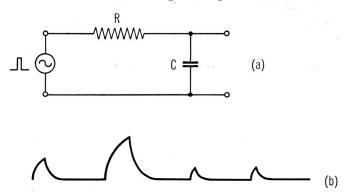
Fig. 2. Aufladung einer Kapazität durch Impulse
