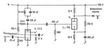
Fig. 12. Schaltung für die Trennung von Bildsynchronimpulsen aus dem Impulsgemisch (625 Zeilen, CCIR-Norm)
