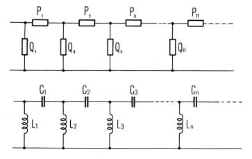
Fig. 8. Laufzeitzweipol der kurzgeschlossenen Leitung gemäss Formeln (14) und (15)
