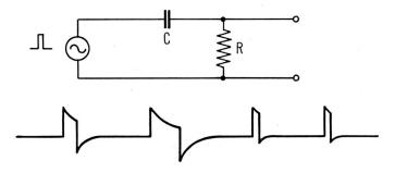
Fig. 3. Entladung einer Kapazität durch Impulse
