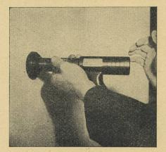
Die schnellste und rationellste Montagemethode im Elektrogewerbe. Schraub- oder Nietbolzen werden mit Munition
