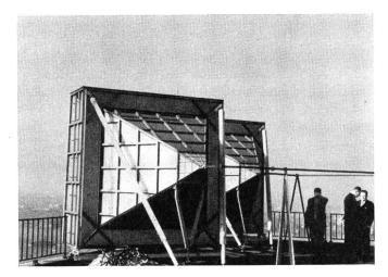
Fig. 1. Antennes à lentille pour 4000 MHz
