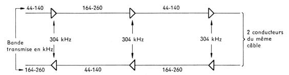
Fig. 10. Schéma des fréquences du système à courants porteurs N
