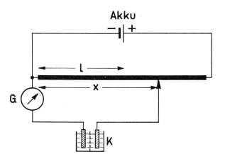
Fig. 9. Schema zur Poggendorf/schen Kompensationsmethode für Potentialmessungen. Zeigt das Galvanometer G Stromlosigkeit an, so ist der Spannungsabfall über der Strecke  $\boldsymbol{x}$  auf dem linearen Widerstandsdraht gleich der E. M. K. der galvanischen Kette K
