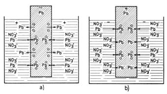
Fig. 7. Bleielektrode in Blei-Ionen-(Eigenionen-)Lösung. Das Blei hat die Tendenz, in Form von Ionen in Lösung zu gehen; die Ionen haben die Tendenz, sich als Blei niederzuschlagen. Die Bleielektrode lädt sich negativ (a) oder positiv (b) auf
