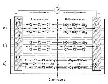
Fig. 8. Die galvanische Kette aus Blei- und Zinkelektrode. Das Potential E ist ein Mass für das Bestreben des Zinks, in Lösung zu gehen, und der Blei-Ionen, sich als Metall niederzuschlagen (a). Fliesst der Strom I, so treten Zinkionen Zn in den Kathodenraum (b) und Nitrationen NO'3 in den Anodenraum (c)
