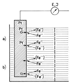
Fig. 12. Eine Redoxelektrode. Fe $^{\cdots}$ -Ionen reduzieren sich zu Fe $^{\cdots}$ -Ionen (a) und Fe $^{\cdots}$ -Ionen oxydieren sich zu Fe $^{\cdots}$ -Ionen (b)
