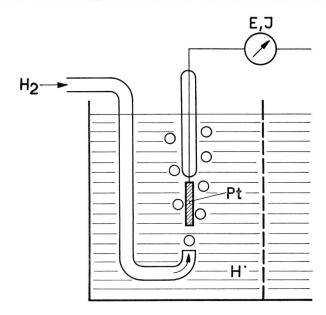
Fig. 11. Die Wasserstoff-Elektrode. Ein Platinblech Pt in einer Lösung mit Wasserstoffionen H $^{\circ}$ , bespült mit Wasserstoffgas H $_2$
