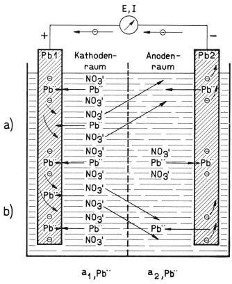
Fig. 10. Die Blei-Konzentrationskette. Die Abscheidungstendenz gegen die Elektrode Pb1 in der konzentrierten Lösung der Aktivität  $a_1$  Pb·· ist grösser als diejenige gegen Pb2 in der verdünnteren Lösung der Aktivität  $a_2$  Pb·· (a). Pb1 lädt sich um E positiv gegen Pb2 (b). Es fliesst ein Elektronenstrom I durch einen Leiter von Pb2 nach Pb1, bis  $a_1$  Pb··  $= a_2$  Pb·· geworden ist
