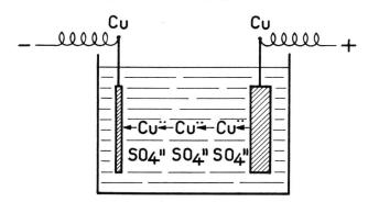
Fig. 6. Kupferelektrolyse. An der Kupferanode gehen Kupferionen Cu<sup>··</sup> in Lösung, an der Kathode werden solche entladen und als Metall niedergeschlagen
