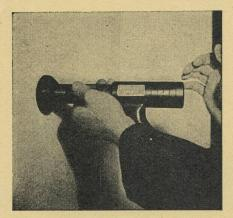
Die schnellste und rationellste Montagemethode im Elektrogewerbe. Schraub- oder Nietbolzen werden mit Munition
