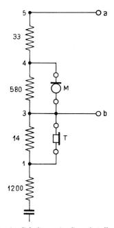
Fig. 4. Schaltung in Sprechstellung
