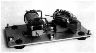
Fig. 2. Innerer Aufbau der Hotelstation
