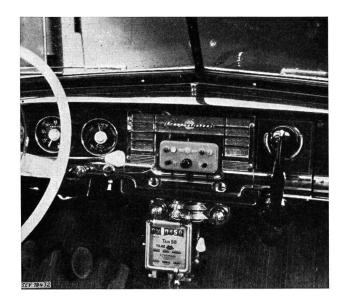
Fig. 6. Bedienungsapparatur in einem Auto-Taxi. Rechts: Mikrotelephon; Mitte: Bedienungsgerät; Signallampen im Bedienungsgerät (von links nach rechts) Rot: Anruflampe
