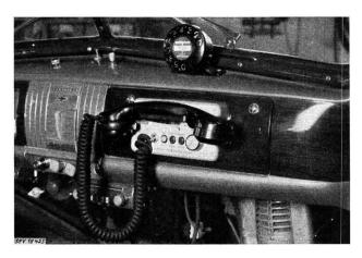
Fig. 7. Bedienungsapparatur einer Anlage für vollautomatischen Verkehr
