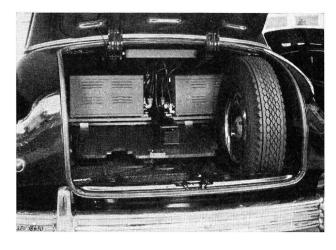
Fig. 4. Einbau der Apparate im Kofferraum eines Auto-Taxi. Links: VHF-FM-Empfänger; Rechts: VHF-FM-Sender; Mitte oben: Frequenzweiche; Mitte vorn: Verteiler Der Holzdeckel ist betriebsmässig hochgeklappt, so dass der ganze Kofferraum neben dem Reserverad für Passagiergepäck zur Verfügung steht
