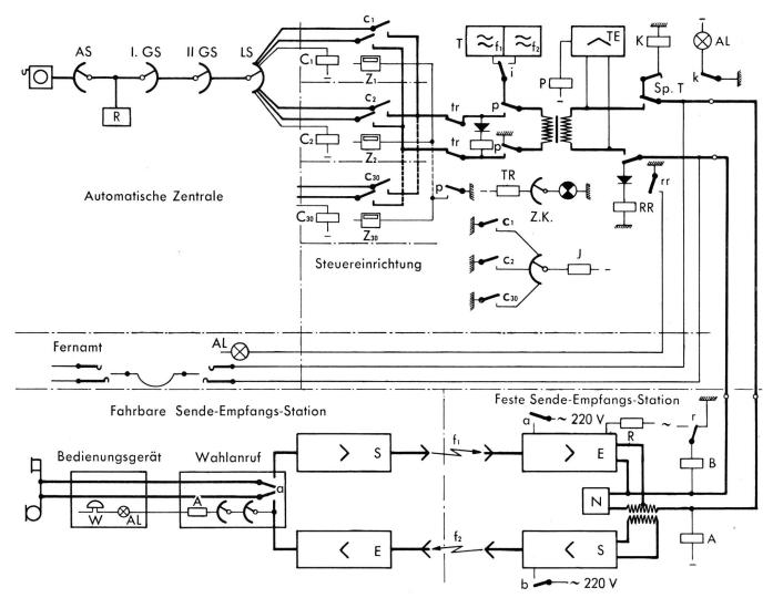
Fig. 2. Vereinfachtes Schaltschema der drahtlosen Telephonanlage für Fahrzeuge
