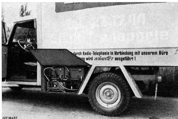
Fig. 5. Einbau der Apparate in einem Express-Camion der Firma Welti-Furrer AG., Zürich
