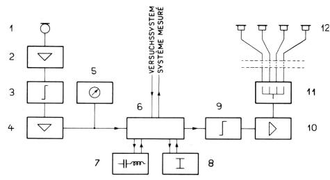
Fig. 2. Blockschema des neuen Ersatzsystems Schéma de principe du nouveau système de référence
