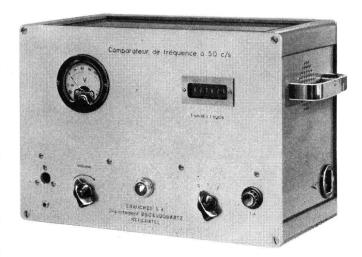
Fig. 3. Comparateur de fréquence
