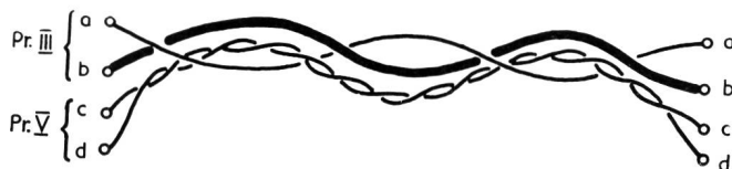
Fig. 6. Nebensprechen bei Parallelführung
