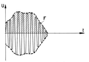
Fig. 3. Stossintegral der Enveloppe
