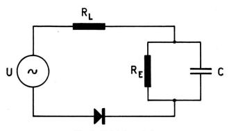
Fig. 6. Detektionsstufe
