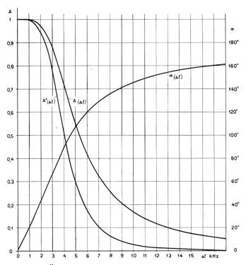
Fig. 1. Die Übertragungsgrössen eines kritisch gekoppelten Bandfilters  $Q=300;\;f_o=1720\;\mathrm{kHz}$
