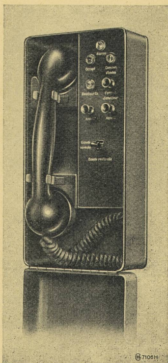
Vue de l'appareil téléphonique monté dans la cabine du mécanicien
