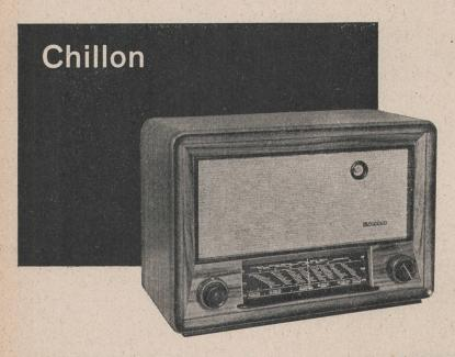
6-Röhren-Super für Kurz-, Mittel- und Langwellen. Das magische Auge erleichtert die Scharfeinstellung. Der eingebaute Konzertlautsprecher (22 cm Ø) mit besonders weicher Einspannung der Membrane bringt auch die Bässe voll und sauber. 5stufige Tonblende. Sehr ansprechendes Hartholzgehäuse, zu jeder Umgebung passend.
