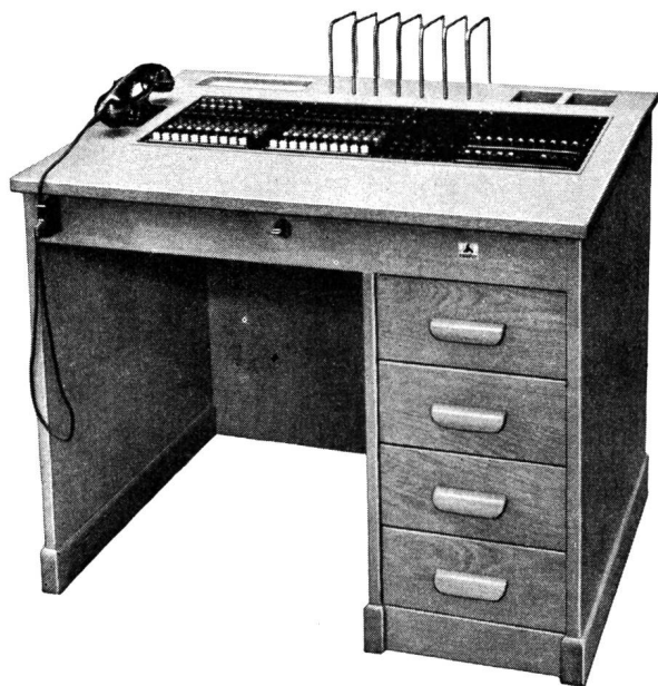
Fig. 1. Schnurloses Vermittlungspult für 20 Amtsleitungen. Zahl der internen Teilnehmer unbegrenzt
