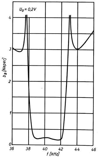
Fig. 21. Betriebsdämpfung des 40-kHz-Filters
