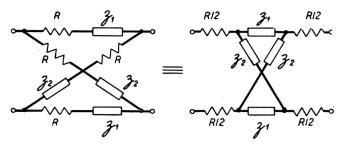
Fig. 16. Brückenschaltung mit ausgeglichenen Verlusten
