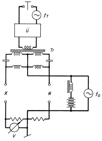
Fig. 10. Schema der Impedanzmessbrücke
