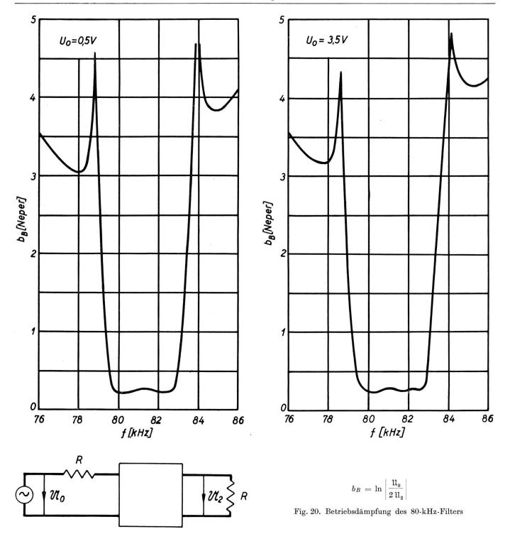
von den strombedingten Impedanzänderungen in den magnetostriktiven Systemen herrühren. Sie äussern sich in einer Verschiebung der Dämpfungspole und rein zufällig in einer Erhöhung der Sperrdämpfung. Der Verlauf im Durchlass zeigt ferner, dass die Pole und Nullstellen der Impedanzen nicht mehr übereinstimmen. Untersucht man die Stromabhängigkeit der Impedanzen einzeln, so stellt man fest, dass sich die Nullstellen bei Erhöhung des Stromes von 0,1 auf 5 mA um folgende Beträge verschieben:
