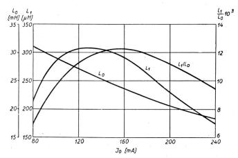
Fig. 11. Stab 1 (Ni-Ferrit). Abhängigkeit der Induktivitäten  $L_0$  und  $L_1$  vom Magnetisierungsstrom  $\boldsymbol{J}_0$
