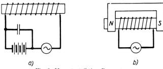
Fig. 6. Magnetostriktive Resonatoren
