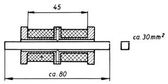
Fig. 9. Antriebsspule (w=1700) mit Probestab
