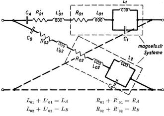
Fig. 19. Schaltung der Versuchsfilter
