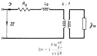
Fig. 7. Elektrische Ersatzschaltung des frei-freien magnetostriktiven Stabes
