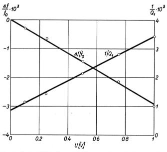
Fig. 12. Stab 2 (NiZn-Ferrit 80:20). Abnahme der Resonanzfrequenz f und Ansteigen des Verlustfaktors  $1/Q_1$  bei wachsender Spannung U am elektromechanischen Schwingkreis (magnetoelastische Hysterese)
