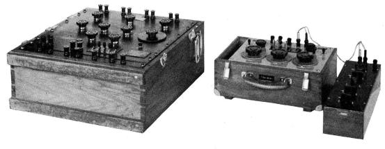
Fig. 7 Impedanz-Messbrücke links = Fabrikat Standard Tel. & Cables, Gewicht 39,8 kg rechts = Kapazitäts-
