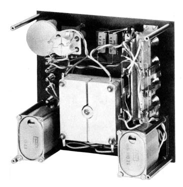
Fig. 10. Kapazitäts-Unsymmetrie-Messbrücke, Modell PTT 50. Innenansicht. Das Gerät enthält auf kleinstem Raume alle zur Kopplungsmessung im Vierer nötigen Mess- und Schaltelemente, ohne dass deren Zugänglichkeit leidet
