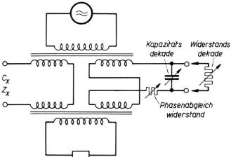
Fig. 6. Prinzipschaltung der Kapazitäts- und Impedanzmessbrücke, Modell 50
