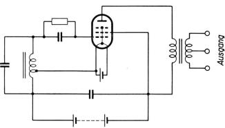
Fig. 14. Prinzipschaltung des Röhrensummers
