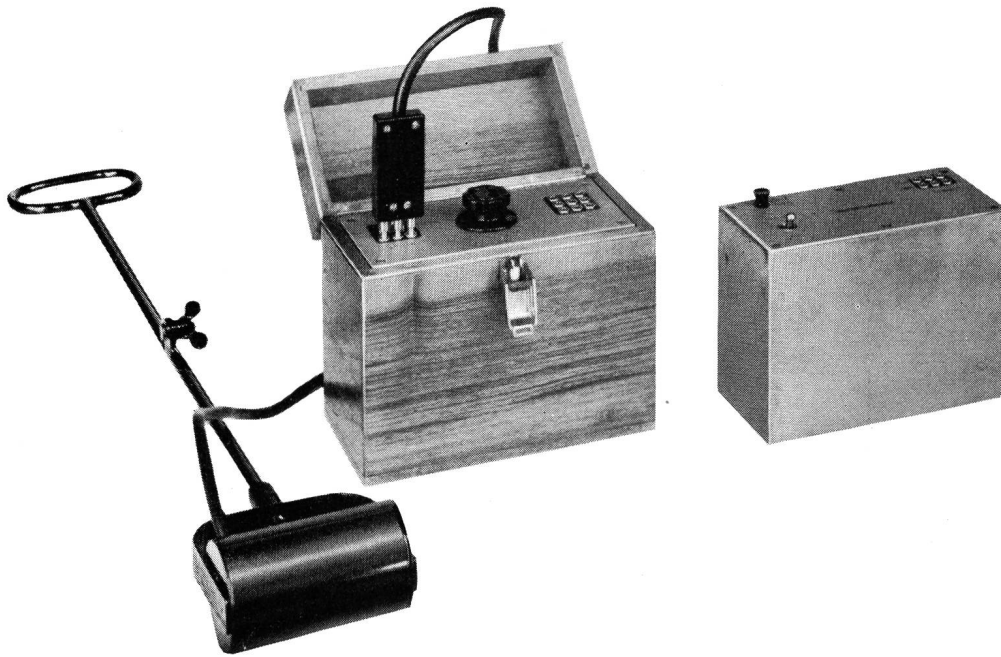
Fig. 13 Zusatzgeräte für Wechselstrom-Messungen im Felde, zugleich Kabelsuch-Garnitur links = Messverstärker im Transportkasten mit Kabelsuchspule rechts = Röhrensummer 800 und 2000 Hz ohne Transportkasten
