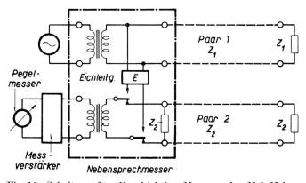
Fig. 16. Schaltung für die objektive Messung der Nah-Nebensprechdämpfung Paar/Paar oder Stamm/Stamm
