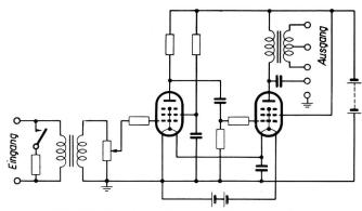
Fig. 15. Prinzipschaltung des Messverstärkers
