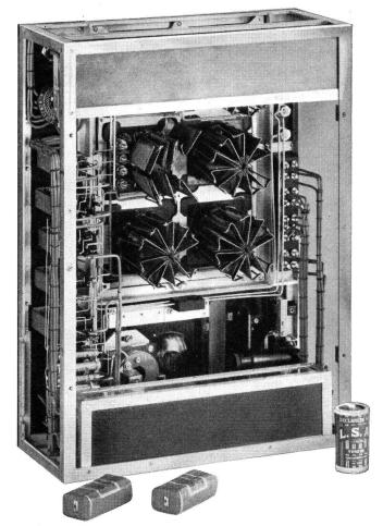
Fig. 3. Kabel-Messeinrichtung Modell PTT 50. Ansicht des Chassis von unten. Die beiden Gehäuse an den Rahmenschmalseiten enthalten die Batterien
