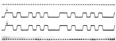
Fig. 3a. Oscillogramme des courants dans le circuit de commande et le circuit de l'armature Oscillogramma delle correnti nei circuiti di comando e di contatto
