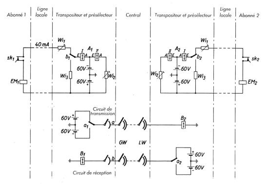
Fig. 5. Circuits de transmission d'une communication par téléscripteur Circuiti telegrafici d'una comunicazione fra telescriventi
