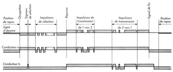
Fig. 7. Succession des commutations sur la ligne d'abonné et les circuits quatre fils — double courant Stato dei raccordi nella linea d'abbonato e nei circuiti a quattro fili e a corrente doppia
