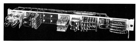
Fig. 8. Présélecteur et transpositeur pour raccordement d'abonné Preselettore e traslazione per abbonato alla telescrivente
