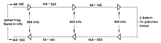
Fig. 10. Frequenzschema des N-Trägersystems
