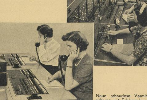
Neue schnurlose Vermittlungseinrichtung mit Zahlengeber für Telephonanlagen mit 20 Amtsleitungen.
