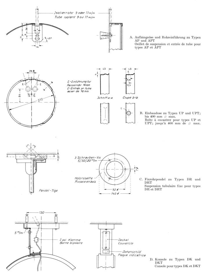
Fig. 3A...C: Einzelheiten der Montage — Détails de montage
