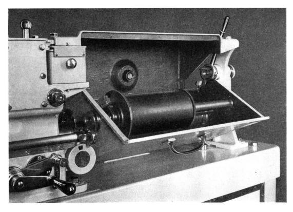
Fig. 4 Empfänger bei geöffneter Dunkelkammer
