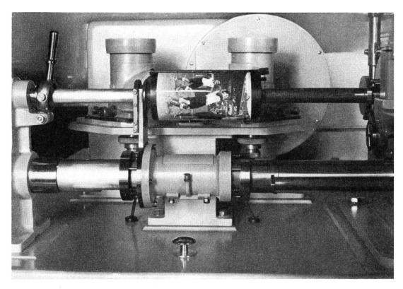
Fig. 3 Sender, mit auf der Trommel aufgespanntem Bild
