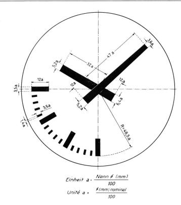
Fig. 1 Zifferblatt der genormten Nebenuhr Cadran de l'horloge secondaire normalisée
