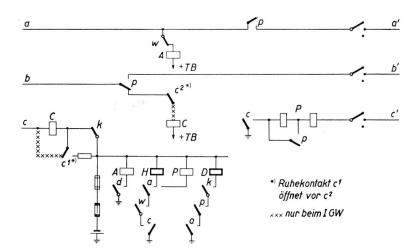
Fig. 9. Prinzipstromlauf des Gruppenwählers
