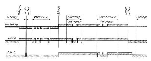
Fig. 7 Schaltzustände in der Teilnehmerleitung und in den Vierdraht-Doppelstromkreisen
