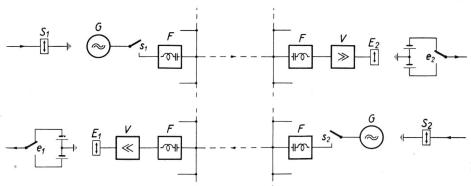
Fig. 13. Prinzipielle Schaltung eines Wechselstromtelegraphie-Kanals
