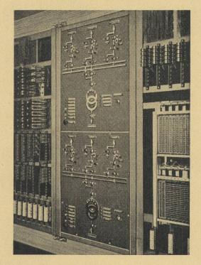
Fernsteuerungsanlage mit Verwendung von Kombinationsrelais und Kreuzwählern
