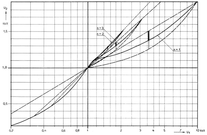
Fig. 7. Genauigkeit der Approximation bei verschiedener Feinheit der Unterteilung. n=Anzahl der linearen Teilstücke je Spannungsdekade;  $R=10~{\rm K}~\varOmega$
