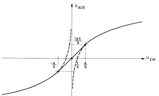
Fig. 1 Kennlinie für das Logarithmieren von Wechselspannungen nach Formel (1)
