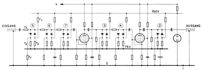
Fig. 10. Schema des logarithmischen Breitband-Verstärkers (eingekreiste Zahlen über den Dioden = fortlaufende Numerierung der zugehörigen linearen Teilstücke der log-Funktion)
