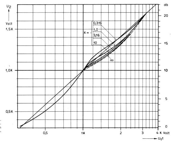
Fig. 9 Einfluss der Diodenvorspannung auf den Verlauf der Approximation (Vorspannung = KVolt,  $n=2,\ R=10\ \mathrm{K}\ \Omega$ )
