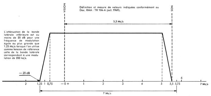
Fig. 1. Caractéristiques d'un émetteur idéal de vision
