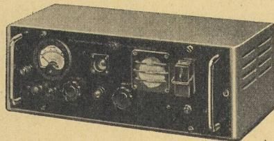
Akustische Anzeige der Ionisation vor dem Erreichen der Durchschlags-Spannung. Dazu optische Kontrolle.
