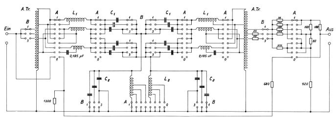
Fig. 2. Schema des  $\frac{1}{3}$ -Oktav-Filters — Schéma du filtre à  $\frac{1}{3}$  d'octave
