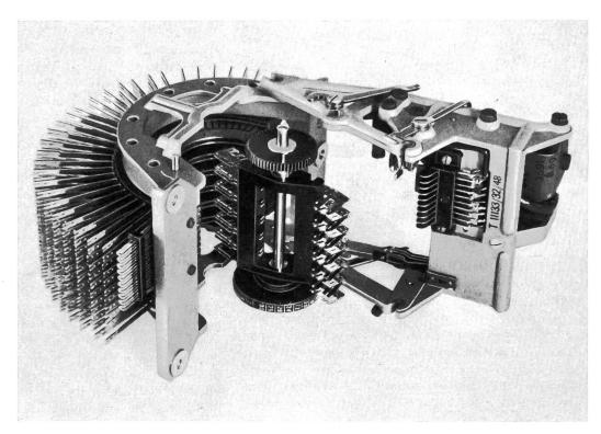
Fig. 7. 30er-Sucher mit Korb, zerlegt Chercheur à 30 positions avec banc de contacts, démonté
