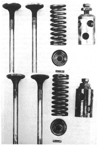
Fig. 3. Ventile, Ventilfedern, Ventilstössel = mit HD-Öl geschmiert (P 718) = mit gemischtbasischem Öl geschmiert (P 720)
