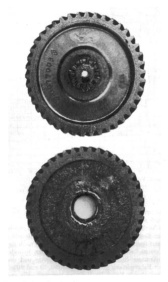
Fig. 4. Nockenwellenzahnrad oben = mit HD-Öl geschmiert (P 718) unten = mit gemischtbasischem Öl geschmiert (P 720)
