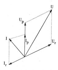
Fig. 4. Tensions et courants dans le cas d'une ligne avec réflexion
