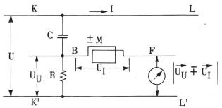
Fig. 2. Schéma de principe d'un localisateur
