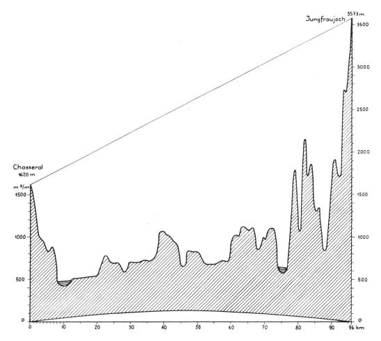
Fig. 2c. Profil Chasseral—Jungfraujoch. Surélévation 25:1
