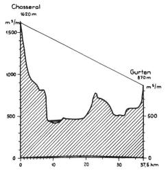
Fig. 2 d. Profil Chasseral—Gurten. Surélévation 25:1. r = 4/3  $\times$  6360 km
