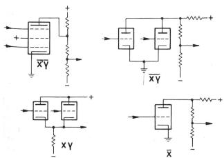
Fig. 3. Kombinationsschaltungen (Prinzip der verteilten Verstärkung)
