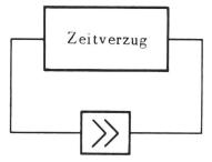
Fig. 5. Prinzip eines dynamischen Registers
