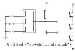
Fig. 2. Konjunktion. Links elektronische, rechts elektromechanische Realisation
