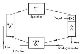
Fig. 6. Blockschema eines dynamischen Registers
