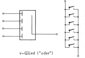
Fig. 1. Disjunktion. Links elektronische, rechts elektromechanische Realisation
