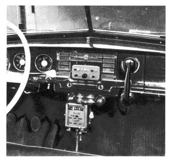
Fig. 2. Bedienungsgerät im Funk-Taxi
