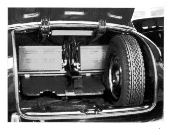
Fig. 3. Die im Kofferraum placierten Sende- und Empfangseinrichtungen. Zum Schutz der Apparaturen sind diese durch einen Holzdeckel vom übrigen Kofferraum abgetrennt. In betriebsmässigem Zustande ist der Holzdeckel hochgeklappt
