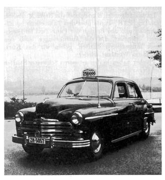
Fig. 1. Funk-Taxi der Fa. Welti-Furrer AG. Auf dem linken Kotflügel befindet sich eine ausziehbare Antenne, die zum Senden und Empfangen dient
