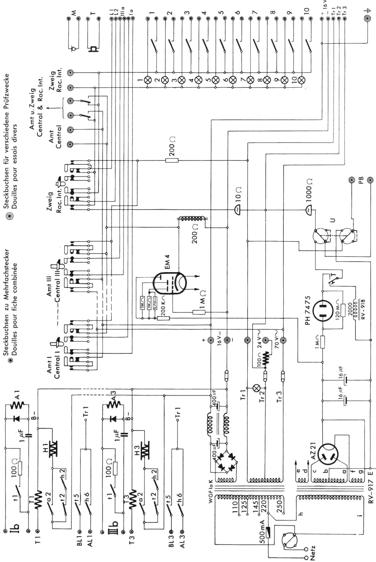
Fig. 6. Schema des Linienvähler-Prüfgerätes, Typ A. — Schéma de l'appareil pour sélecteur de lignes, Type A.
