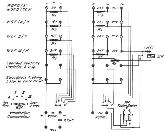
Fig. 8. Widerstandskästen für die Belastungsprüfung von Speisegleichrichtern, WGF-Typen
