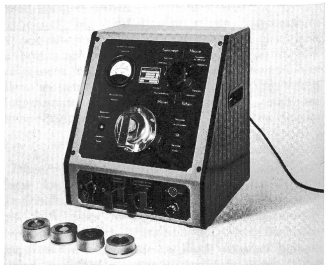
Fig. 3. Hörerkapsel-Prüfgerät Appareil d'essai pour capsules d'écoute
