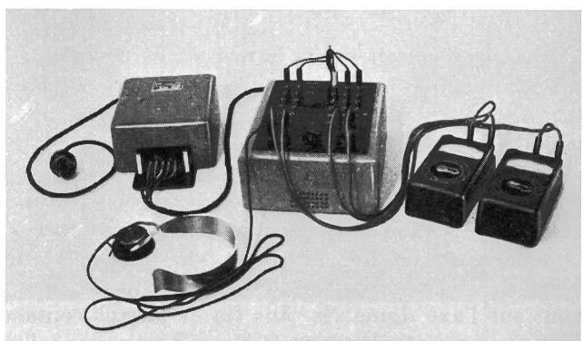
Fig. 7. Prüfkasten für Trockengleichrichter, WGF-Typen
