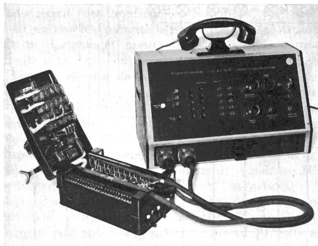
Fig. 5. Prüfgerät für Linienwähler, Typ A
