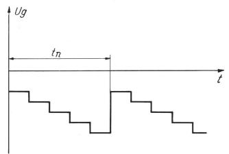
Fig. 8. Steuerspannung der Helligkeit
