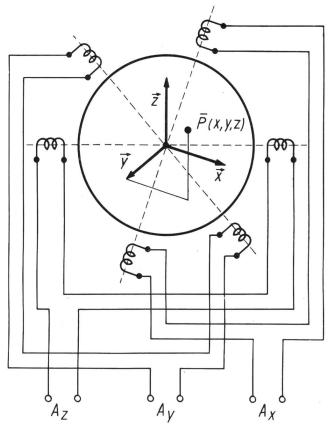
Fig. 2. Elektromagnetische Ablenkung mit drei Spulenpaaren
