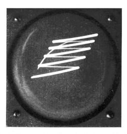
Fig. 13. Die Frequenz der x-Sägezahnschwingung ist nicht genügend hoch
