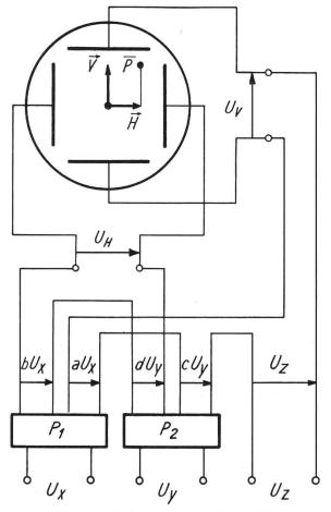
Fig. 4. Schematische Anordnung der Ablenkfelderzeuger
