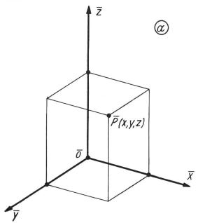
Fig. 1. Isometrische Abbildung des Raumpunktes P (x, y, z) auf der Bildebene  $\alpha$
