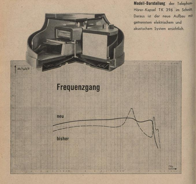
Die Hörerkapsel TK 396 Modell PTT ist eine vollständige Neuentwicklung der AUTOPHON AG-Solothurn. Das Kurvenblatt zeigt deutlich, dass eine bedeutende Verbesserung der Übertragung gegenüber bisherigen Kapseln erreicht worden ist.
