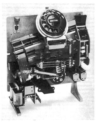
Fig. 2. Auswechselbarer Mechanismus für Münzfernsprecher für vollautomatischen Orts- und Fernverkehr
