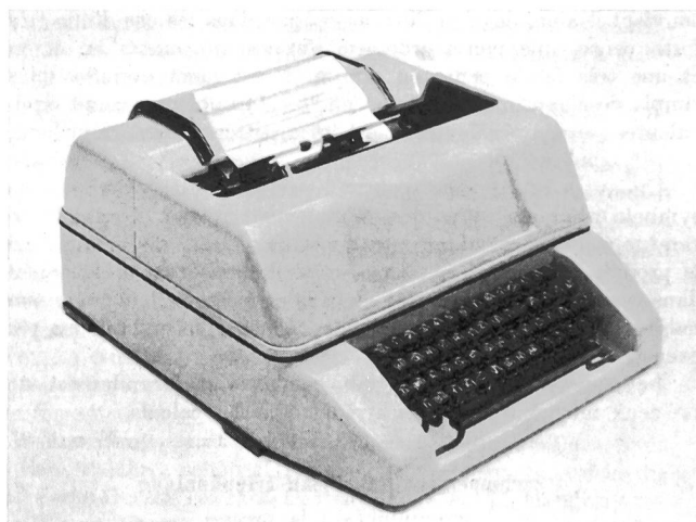
Fig. 3. Prototyp des Fernschreibers
